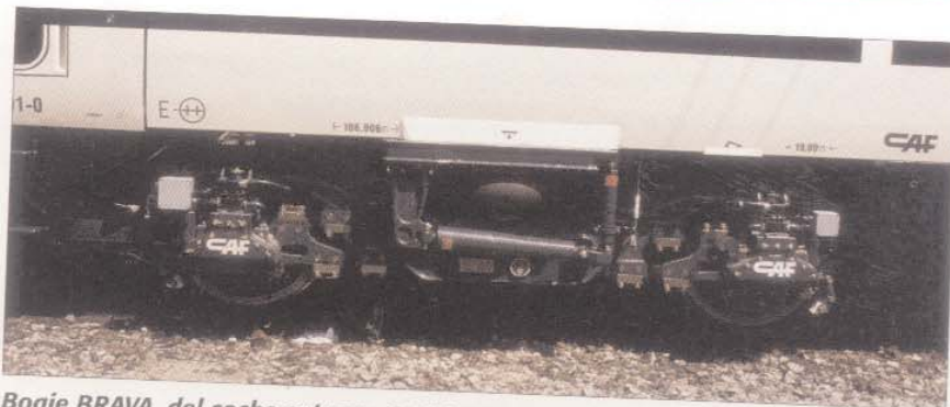
Bogie BRAVA, del coche extremo 9-120-601-0.
