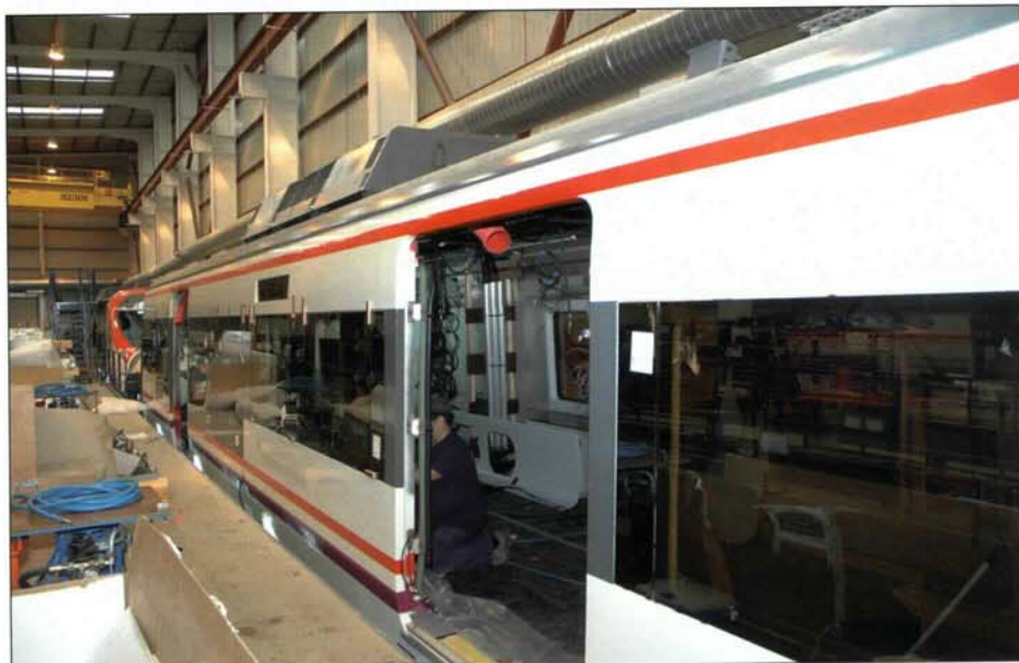
Trabajos de acabado de las unidades Civia, de segunda generación, en la factoría de Linares.
