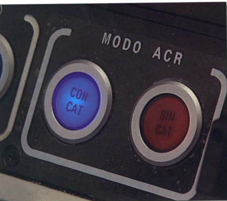
Conmutadores instalados en la cabina de conducción, donde se indica el estado del pantógrafo durante la circulación.
