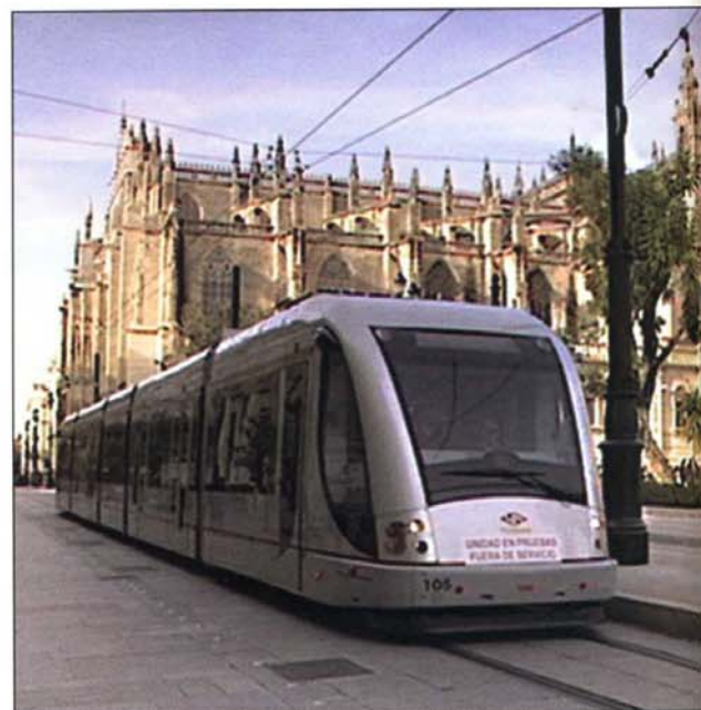
Unidad 105 en pruebas, por el centro de Sevilla, en la que podemos apreciar el tramo de circulación sin pantógrafo.
