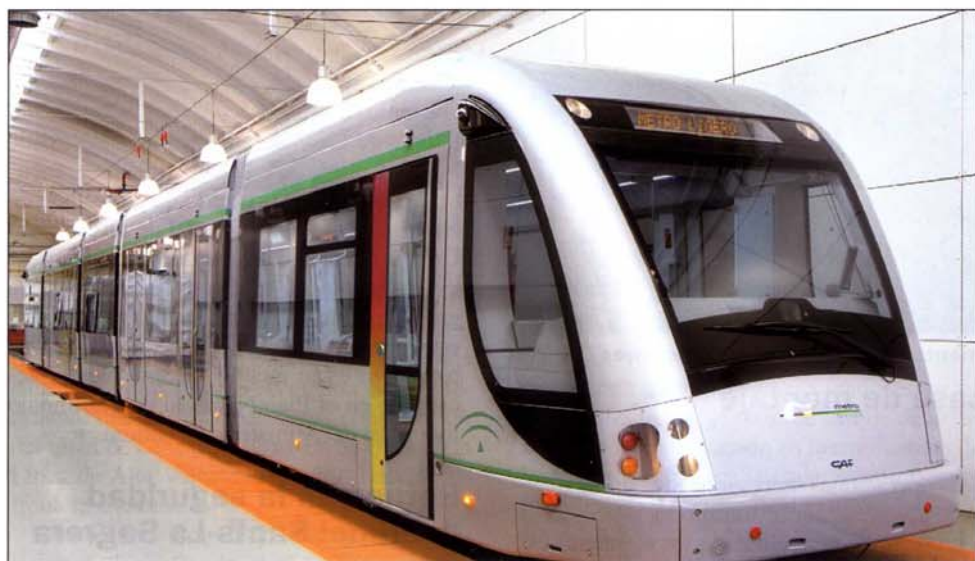
Las unidades bidireccionales están constituidas por cinco cajas articuladas.
